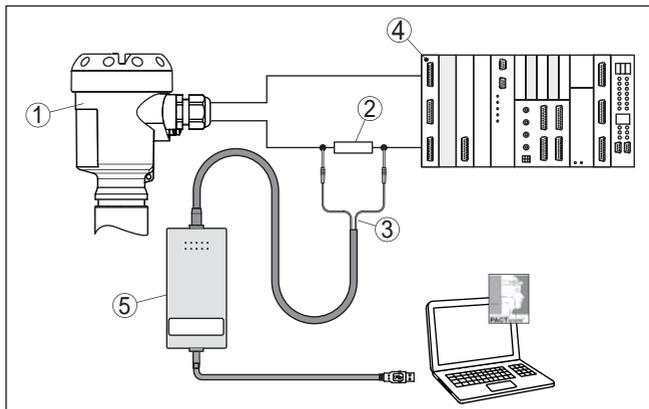
Fig. 29: Conexão do PC à linha de sinais via HART
