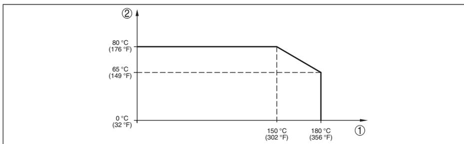
Fig. 39: Redução de temperatura IPT-2x, modelo até +180 °C (+356 °F)
