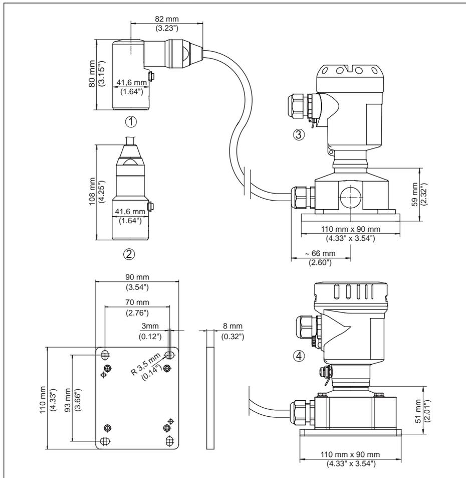
Fig. 48: Modelo IP68 (25 bar) com caixa externa
