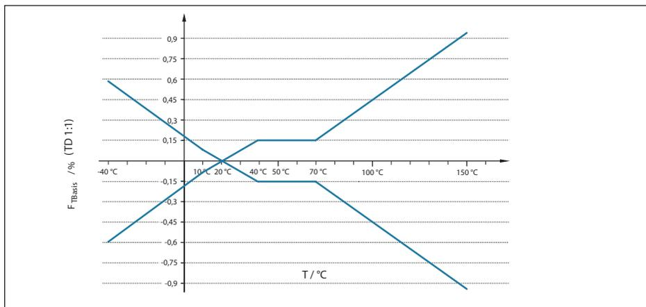
Fig. 33: Erro de temperatura básico  $F_{TBasis}$  com TD 1 : 1
