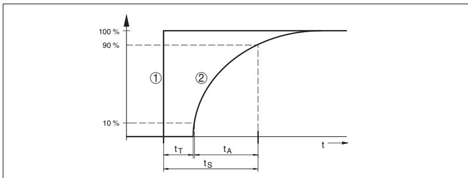
Fig. 32: Comportamento em caso de alteração repentina da grandeza do processo.  $t_T$ : tempo morto;  $t_A$ : tempo de subida;  $t_S$ : tempo de resposta do salto
