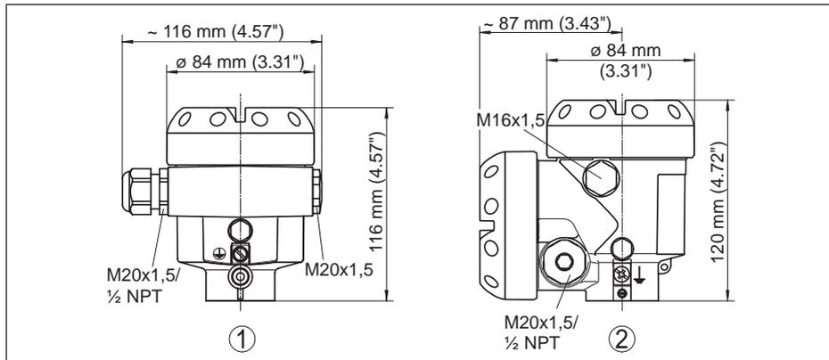
Fig. 43: Variantes da caixa com grau de proteção IP66/IP68 (0,2 bar), (com o módulo de visualização e configuração montado, a altura da caixa é aumentada em 9 mm/0,35 in)
