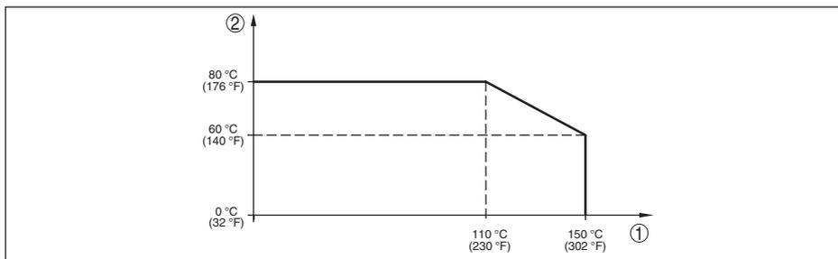
Fig. 38: Redução de temperatura IPT-2x, modelo até +150 °C (+302 °F)
