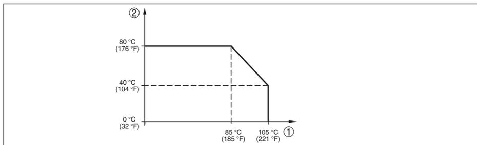
Fig. 36: Redução de temperatura IPT-2x, modelo até +105 °C (+221 °F)
