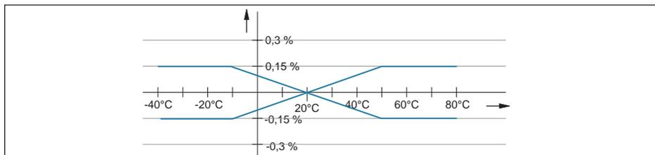
Fig. 35: Alteração térmica da saída de corrente
