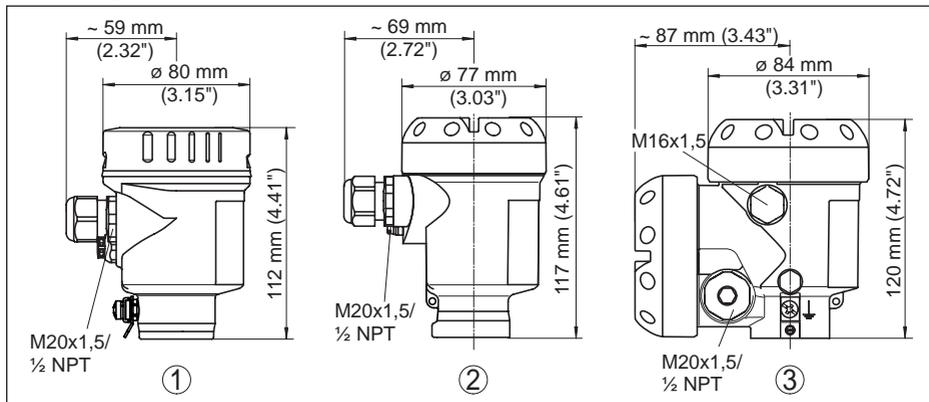
Fig. 45: Variantes da caixa com grau de proteção IP66/IP68 (0,2 bar), (com o módulo de visualização e configuração montado, a altura da caixa é aumentada em 9 mm/0,35 in)
