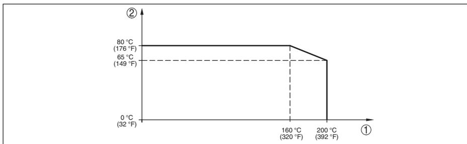
Fig. 40: Redução de temperatura IPT-2x, modelo até +200 °C (+392 °F)
