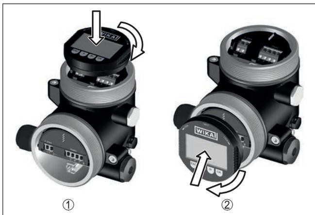
Fig. 26: Colocação do módulo de visualização e configuração na caixa de duas câmaras
