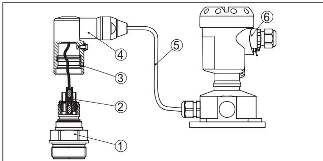
Fig. 31: IPT-2x como modelo IP68 de 25 bar e saída lateral do cabo, caixa externa
