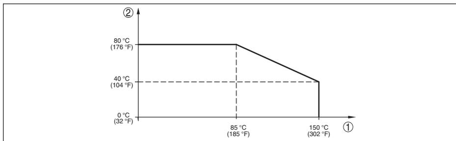
Fig. 37: Redução de temperatura IPT-2x, modelo até +150 °C (+302 °F)
