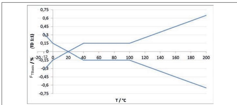
Fig. 34: Erro de temperatura básico  $F_{TBasic}$  com TD 1 : 1
