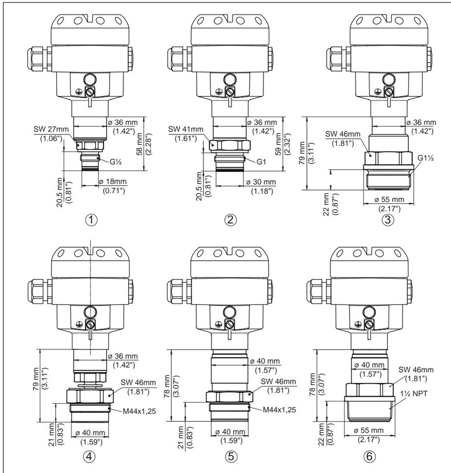
Fig. 50: IPT-2x, conexão rosca embutida na frente
