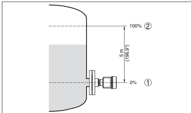
Fig. 28: Exemplo de parametrização Calibração Mín./Máx. Medição do nível de enchimento
