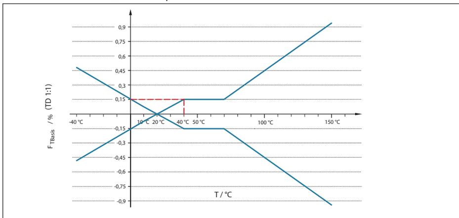
Fig. 41: Cálculo do erro de temperatura básico para o exemplo acima  $F_{TBasis} = 0,15\%$ :
