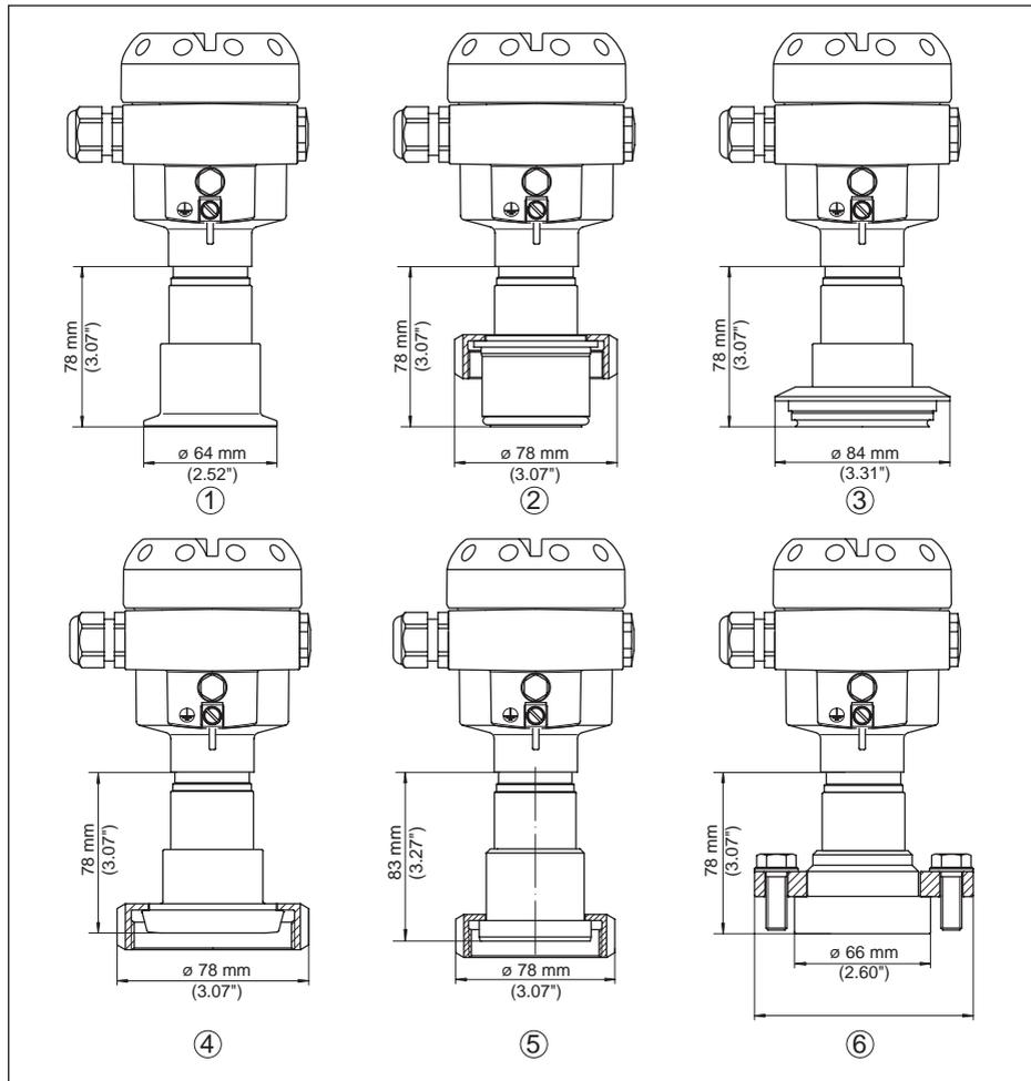
Fig. 52: IPT-2x, conexão asséptica 150 °C (célula de medição metálica/cerâmica)
