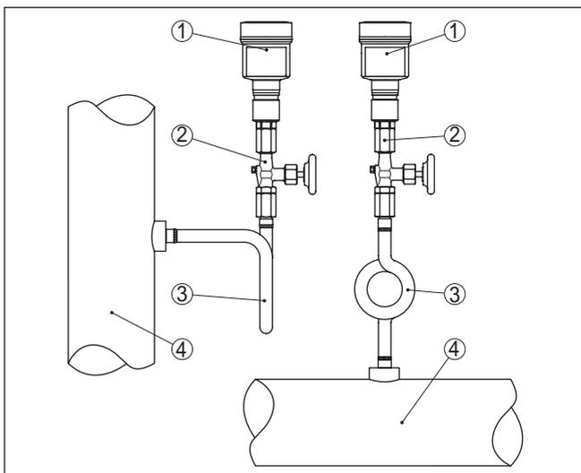
Fig. 12: Disposition de mesure pour la mesure de pression process de vapeurs dans des conduites
