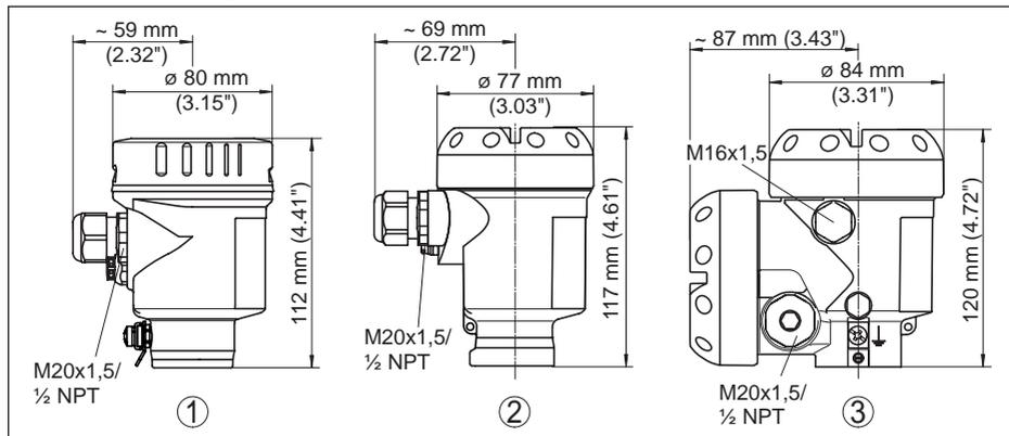
Fig. 45: Variants de boîtier en protection IP66/IP68 (0,2 bar), (avec un module de réglage et d'affichage intégré, la hauteur du boîtier augmente de 9 mm/0.35 in)
