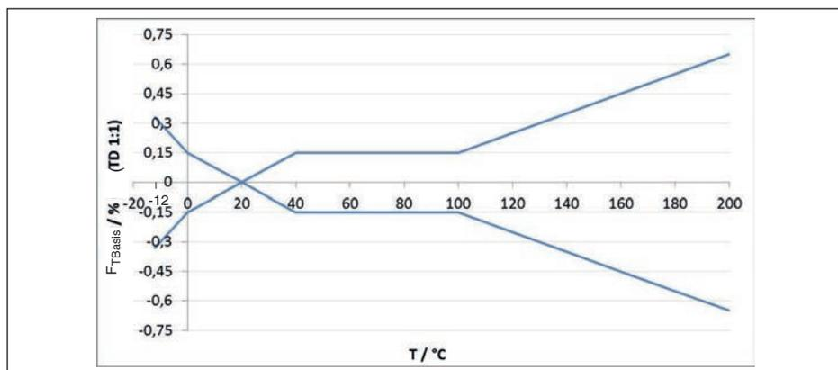
Fig. 34: Erreur de température de base  $F_{TBasis}$  avec TD 1 : 1
