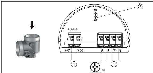
Fig. 18: Compartiment électronique - boîtier à deux chambres
