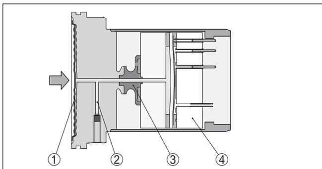
Fig. 5: Structure de la cellule de mesure céramique/métallique
