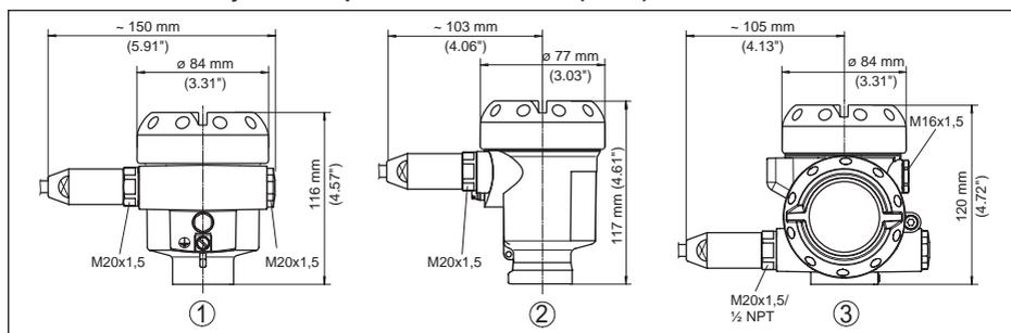
Fig. 46: Variants de boîtier en protection IP66/IP68 (1 bar), (avec un module de réglage et d'affichage intégré, la hauteur du boîtier augmente de 9 mm/0.35 in)
