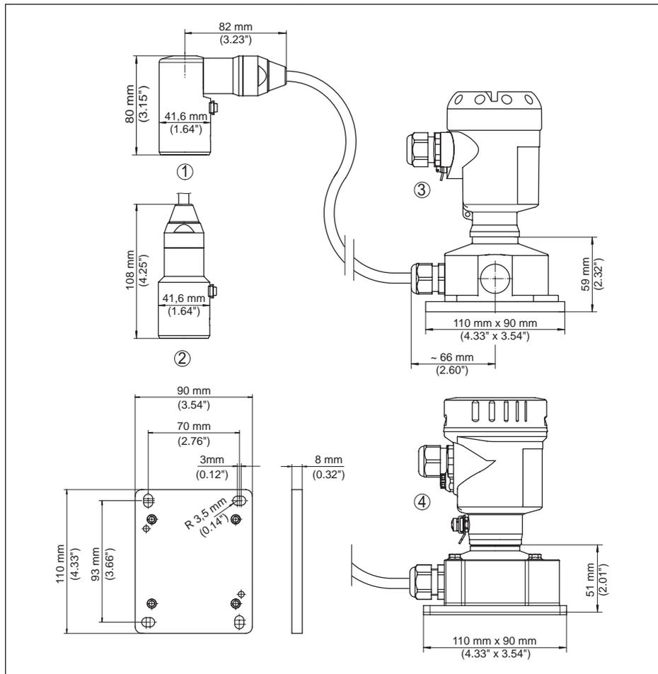
Fig. 48: Version IP68 (25 bar) avec boîtier externe
