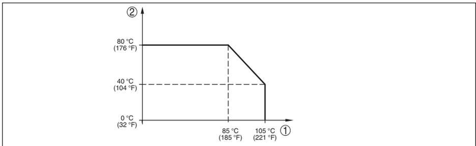
Abb. 36: Temperaturderating IPT-2x, Ausführung bis +105 °C (+221 °F)
