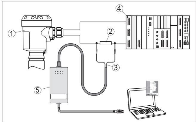
Abb. 29: Anschluss des PCs via HART an die Signalleitung
