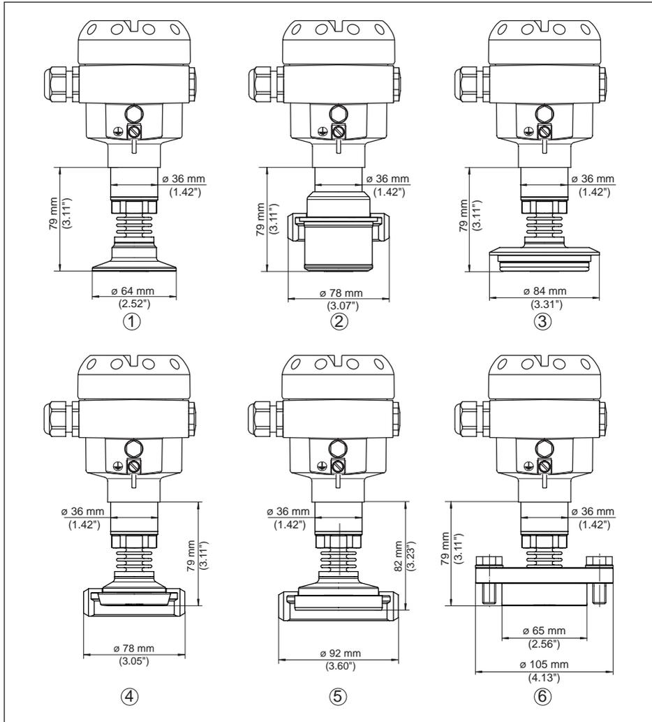
Abb. 51: IPT-2x, Hygieneanschluss 150 °C (piezoresistive-/DMS-Messzelle)
