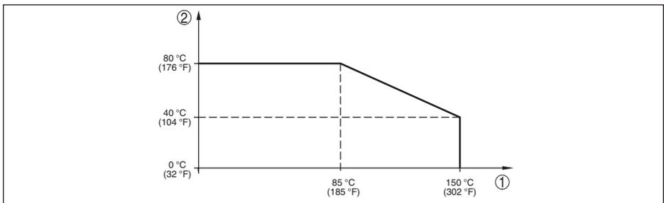
Abb. 37: Temperaturderating IPT-2x, Ausführung bis +150 °C (+302 °F)
