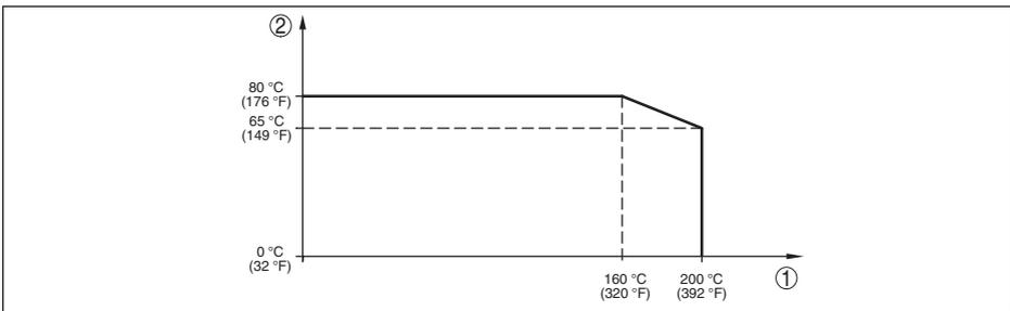
Abb. 40: Temperaturderating IPT-2x, Ausführung bis +200 °C (+392 °F)
