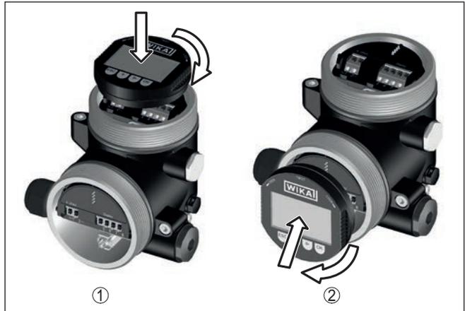
Abb. 26: Einsetzen des Anzeige- und Bedienmoduls beim Zweikammergehäuse
