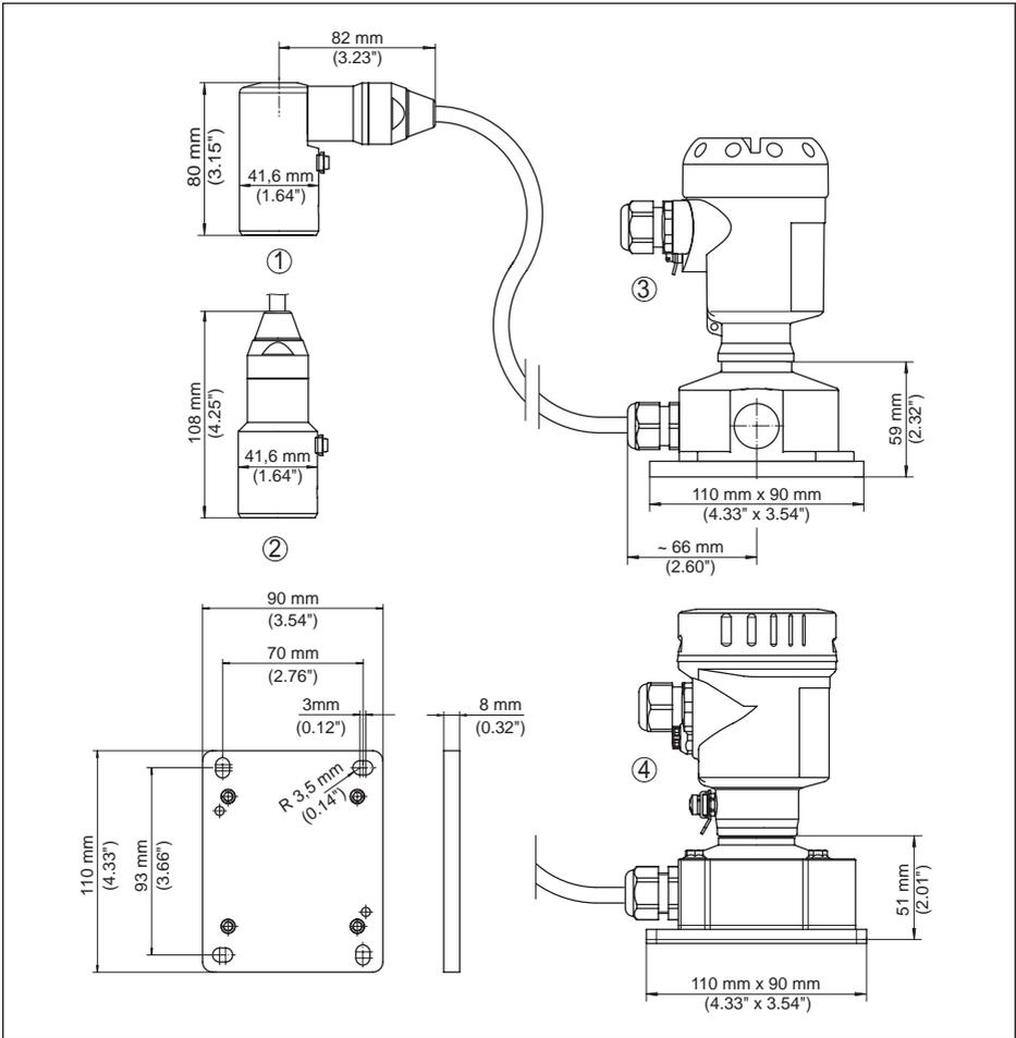
Abb. 48: IP68 (25 bar)-Ausführung mit externem Gehäuse
