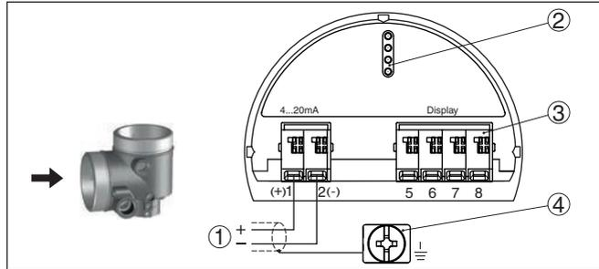
Abb. 19: Anschlussraum - Zweikammergehäuse
