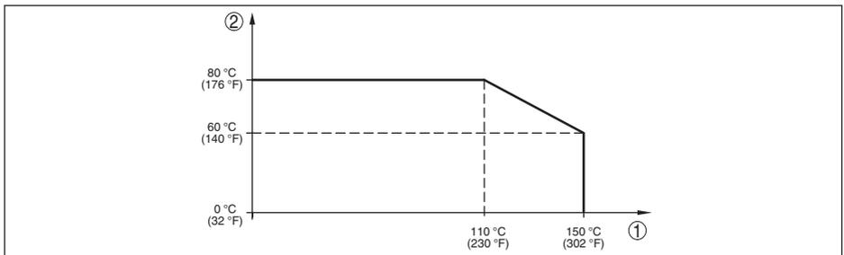
Abb. 38: Temperaturderating IPT-2x, Ausführung bis +150 °C (+302 °F)
