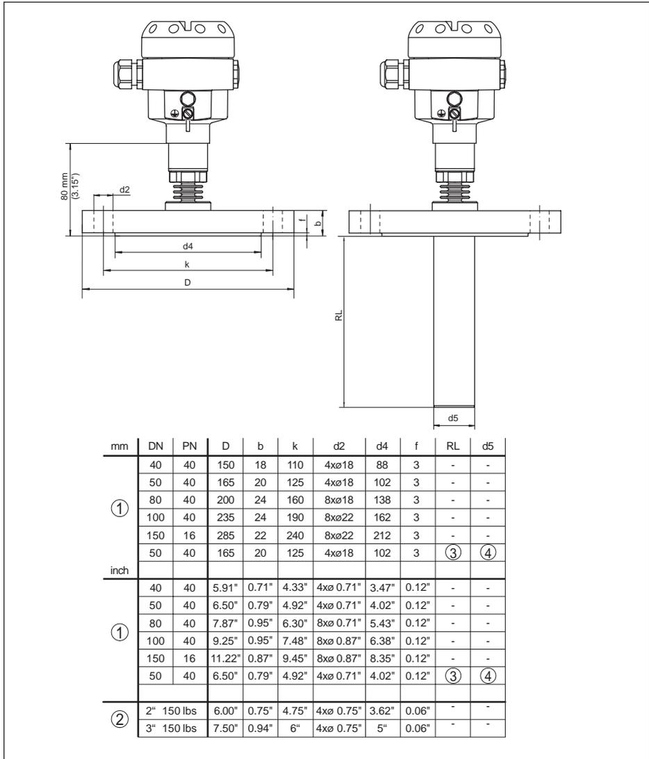
Abb. 53: IPT-2x, Flanschanschluss 150 °C (piezoresistive-/DMS-Messzelle)
