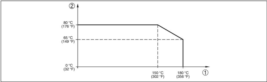
Abb. 39: Temperaturderating IPT-2x, Ausführung bis +180 °C (+356 °F)
