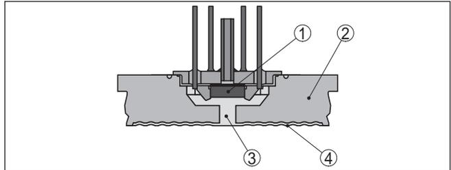
Abb. 3: Aufbau des Messsystems mit piezoresistivem Sensorelement
