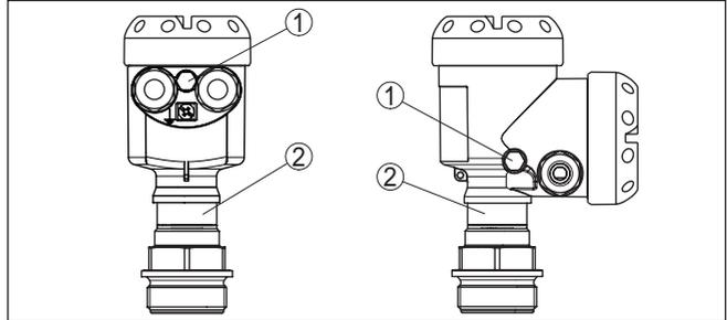
Abb. 9: Position des Filterelementes - gasdichte Durchführung
