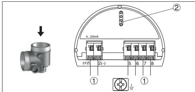
Abb. 18: Elektronikraum - Zweikammergehäuse
