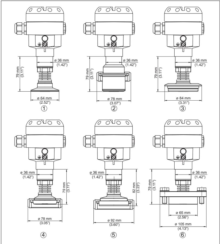
Abb. 51: IPT-2x, Hygieneanschluss 150 °C (piezoresistive-/DMS-Messzelle)
