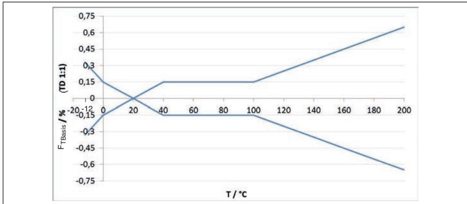
Abb. 34: Basis-Temperaturfehler  $F_{TBasis}$  bei TD 1 : 1
