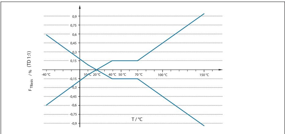
Abb. 33: Basis-Temperaturfehler  $F_{TBasis}$  bei TD 1 : 1
