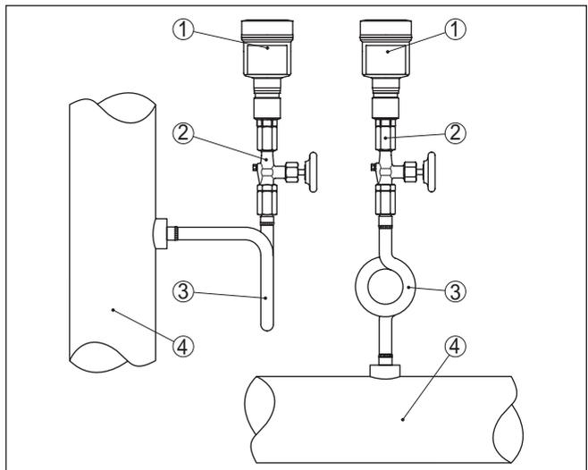
Abb. 12: Messanordnung bei der Prozessdruckmessung von Dämpfen in Rohrleitungen
