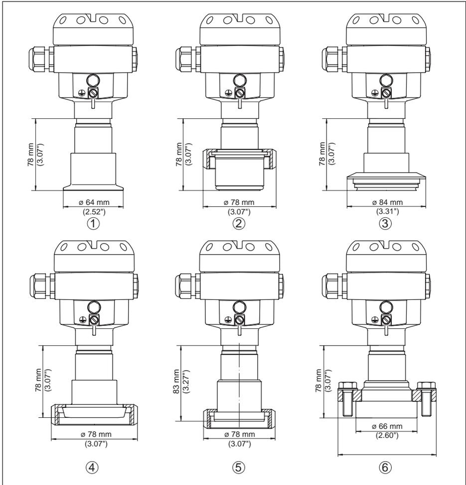
Abb. 52: IPT-2x, Hygieneanschluss 150 °C (metallisch/keramische Messzelle)
