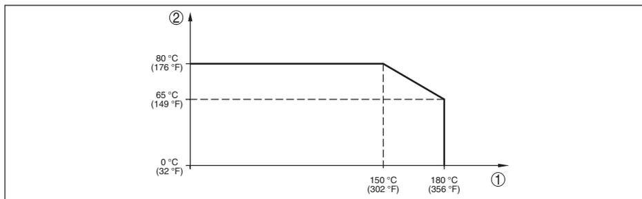
Fig. 37: Redução de temperatura IPT-2x, modelo até +180 °C (+356 °F)
