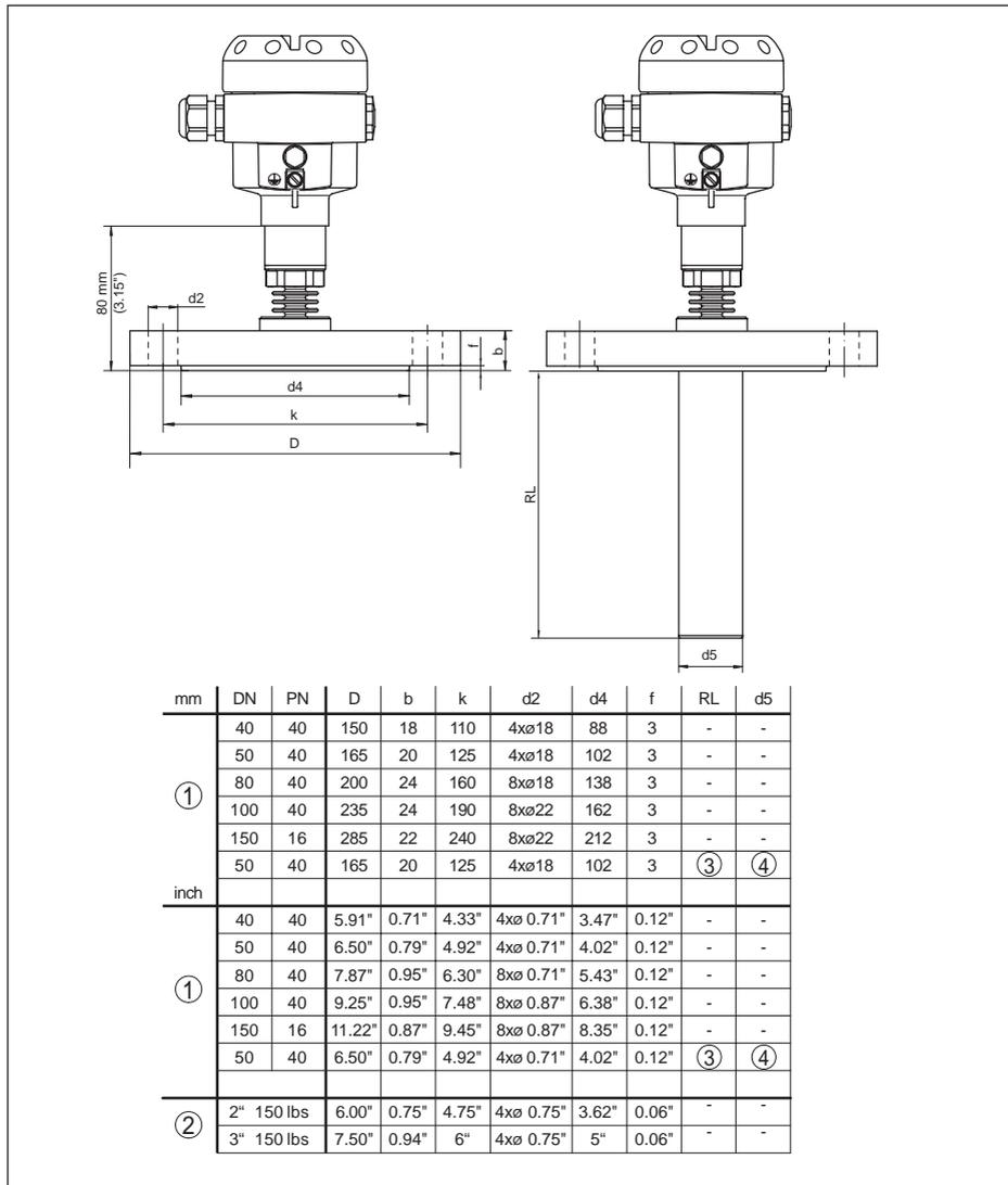
Fig. 51: IPT-2x, conexão de flange 150 °C (célula de medição piezo-resistiva/DMS)
