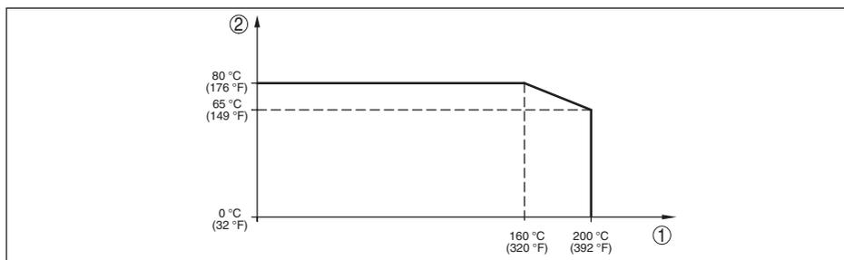
Fig. 38: Redução de temperatura IPT-2x, modelo até +200 °C (+392 °F)
