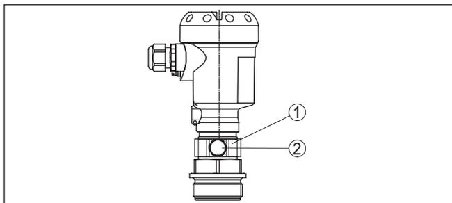
Fig. 8: Posição do elemento de filtragem - Modelo Ex-d
