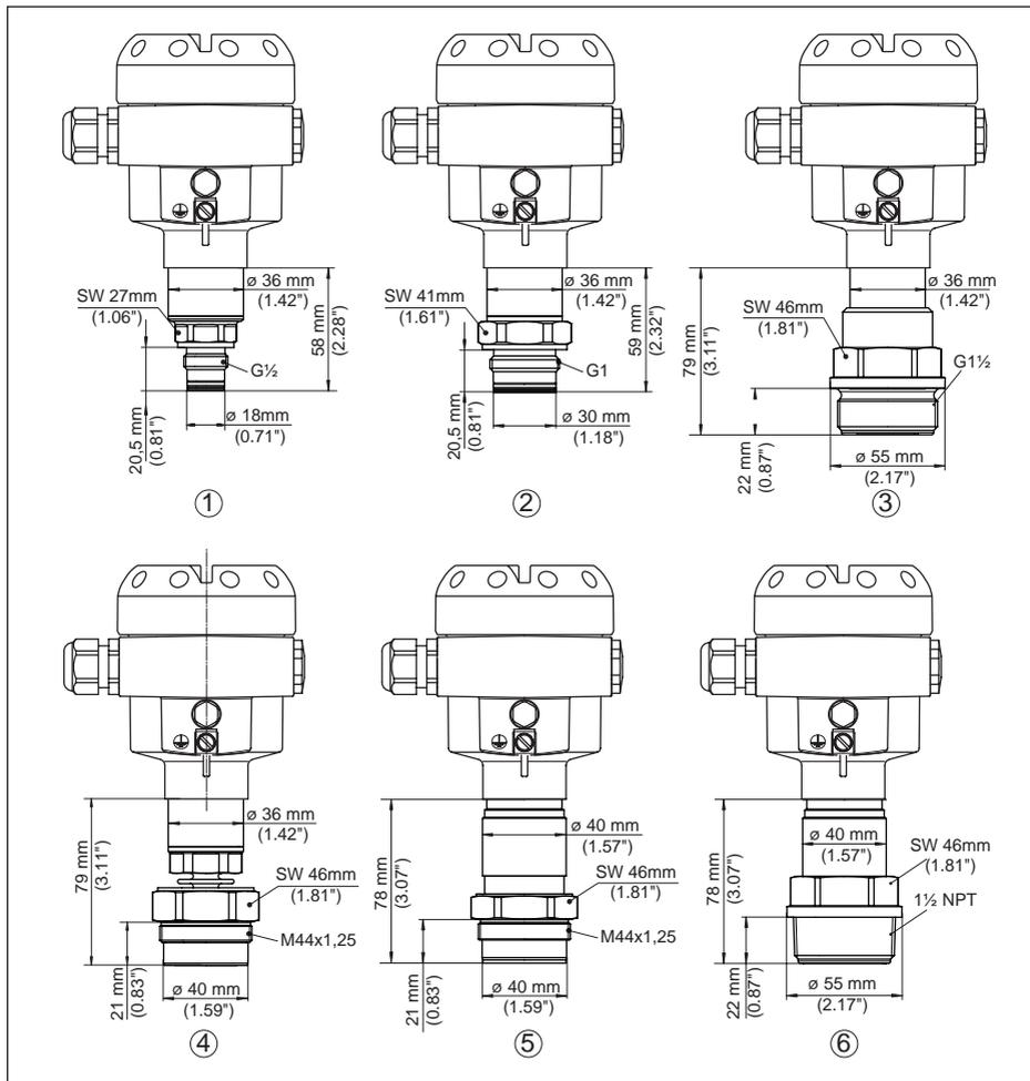
Fig. 48: IPT-2x, conexão rosca embutida na frente
