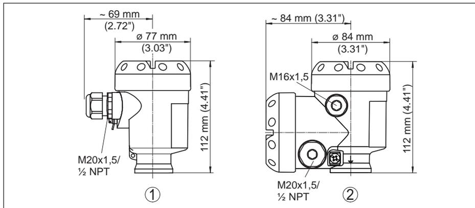
Fig. 40: Variantes da caixa com proteção IP66/IP67 (com o módulo de leitura e comando montado, a altura da caixa é aumentada em 9 mm/0,35 in)
