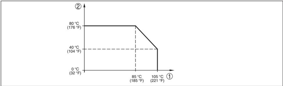
Fig. 34: Redução de temperatura IPT-2x, modelo até +105 °C (+221 °F)
