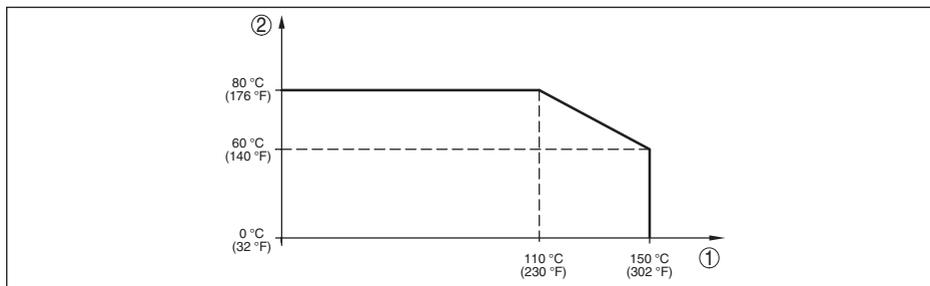
Fig. 36: Redução de temperatura IPT-2x, modelo até +150 °C (+302 °F)
