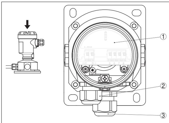
Fig. 22: Compartimento do sistema eletrônico e de conexão
