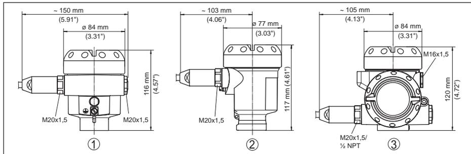
Fig. 44: Variantes da caixa com classe de proteção contra corpos estranhos e umidade com grau de proteção IP66/IP68 (1 bar), (com o módulo de visualização e configuração montado, a altura da caixa é aumentada em 9 mm/0,35 in)
