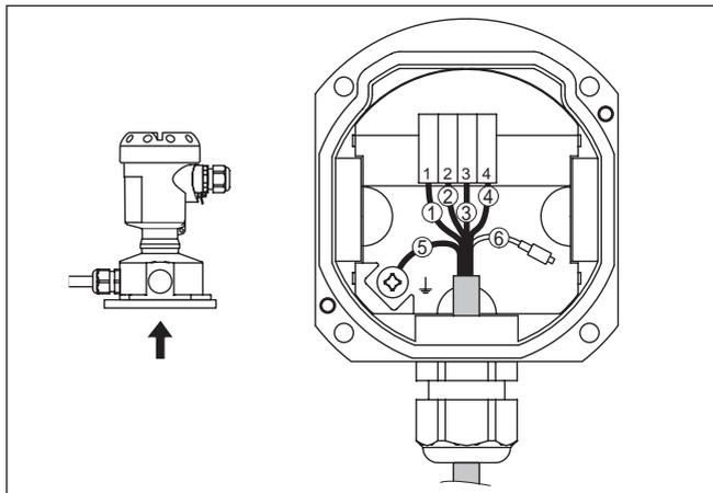
Fig. 23: Conexão do módulo de processo na base da caixa
