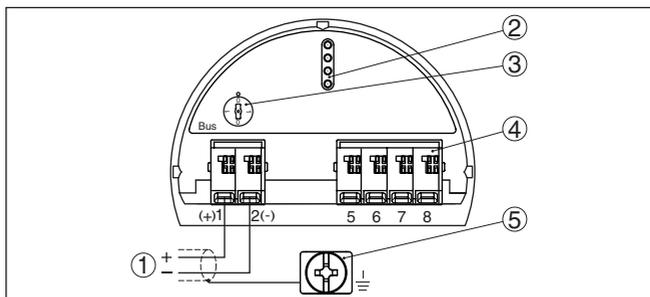
Fig. 24: Compartimento do sistema eletrônico e de conexões - Caixa de uma câmara
