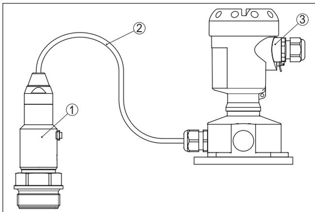
Fig. 21: IPT-2x como modelo IP68 de 25 bar com saída axial do cabo, caixa externa
