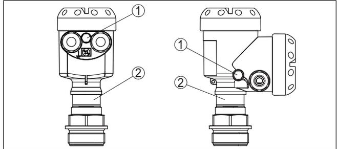
Fig. 9: Posição do elemento de filtragem - Passagem hermética
