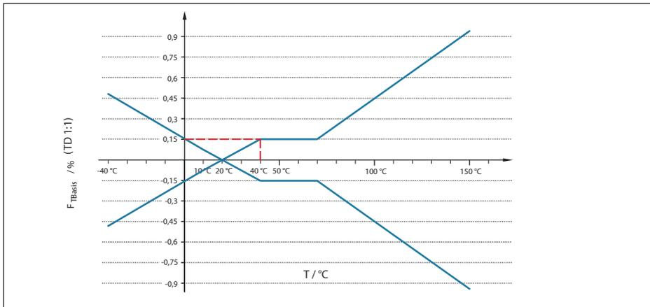
Fig. 39: Cálculo do erro de temperatura básica para o exemplo acima  $F_{TBasis} = 0,15\%$ :
