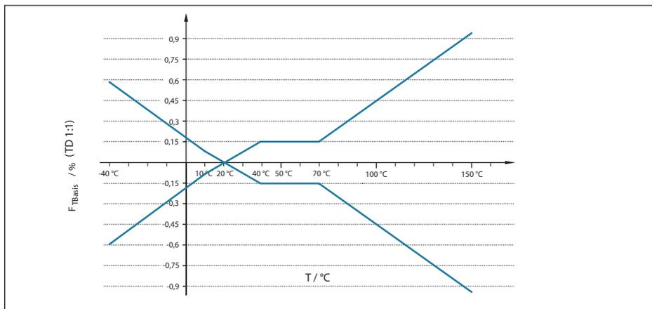
Fig. 32: Erro de temperatura básico  $F_{TBasis}$  com TD 1 : 1
