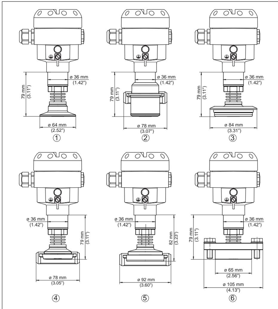
Fig. 49: IPT-2x, conexão higiênica 150 °C (célula de medição piezo-resistiva/DMS)
