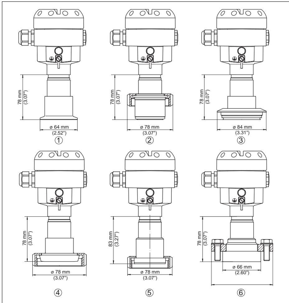
Fig. 50: IPT-2x, conexão asséptica 150 °C (célula de medição metálica/cerâmica)
