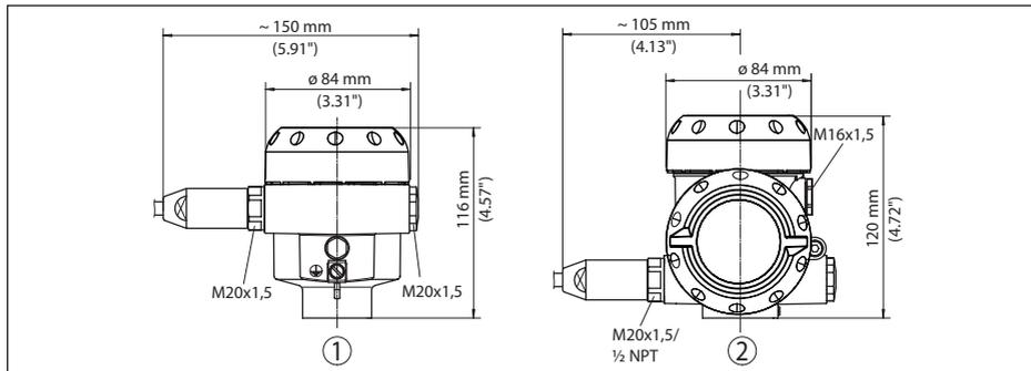
Fig. 42: Variantes da caixa com classe de proteção contra corpos estranhos e umidade com grau de proteção IP66/IP68 (1 bar), (com o módulo de visualização e configuração montado, a altura da caixa é aumentada em 9 mm/0,35 in)
