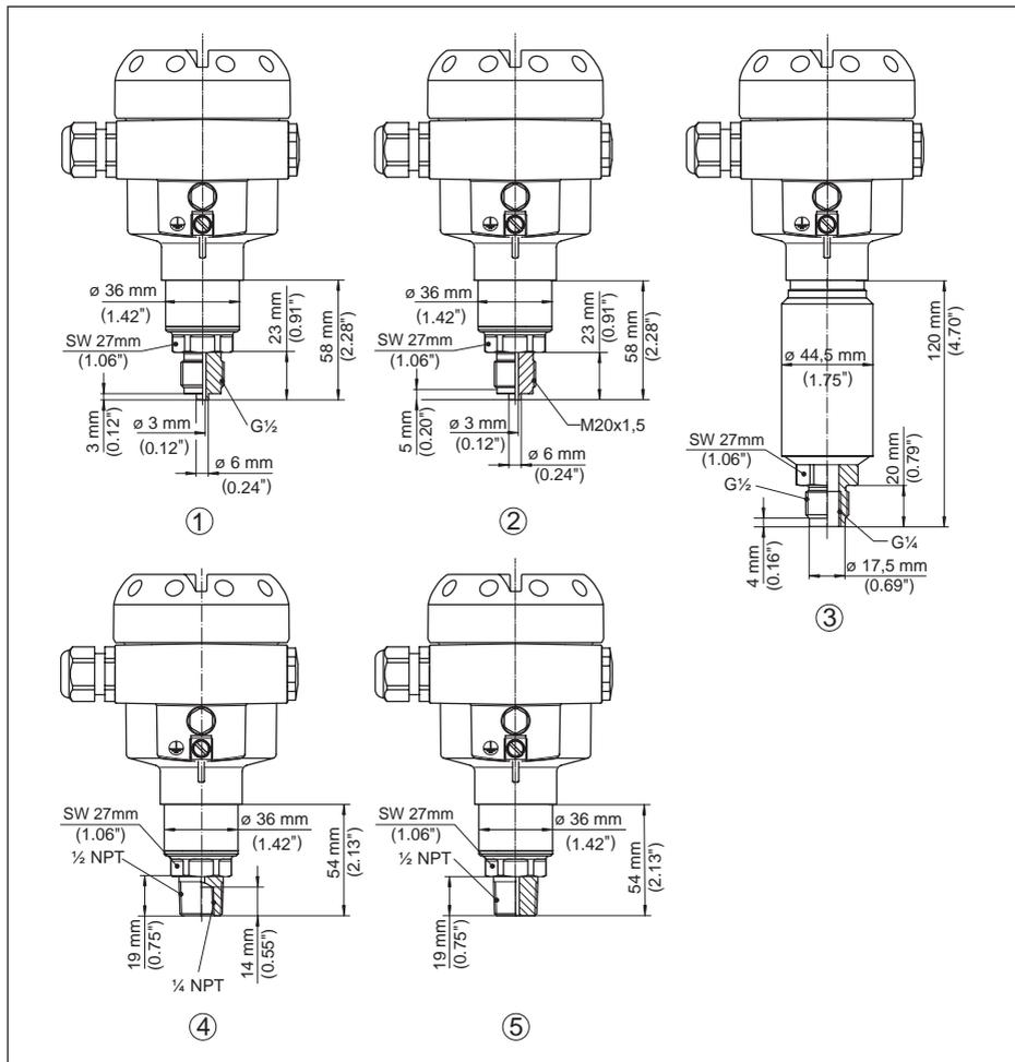
Fig. 47: IPT-2x, conexão rosca não embutida na frente
