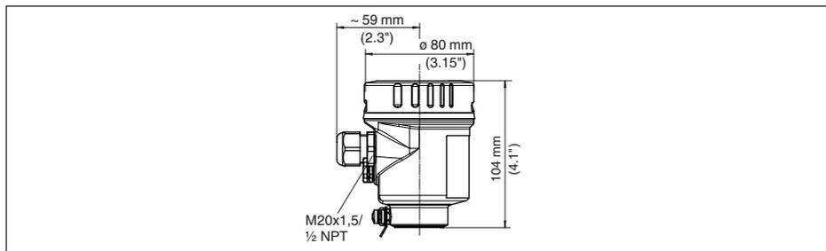
Fig. 45: Modelo da caixa com grau de proteção IP69K (com o módulo de leitura e comando montado, a altura da caixa é aumentada em 9 mm/0,35 in)
