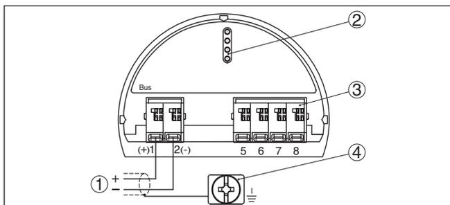
Fig. 19: Compartimento de conexão - Caixa de duas câmaras
