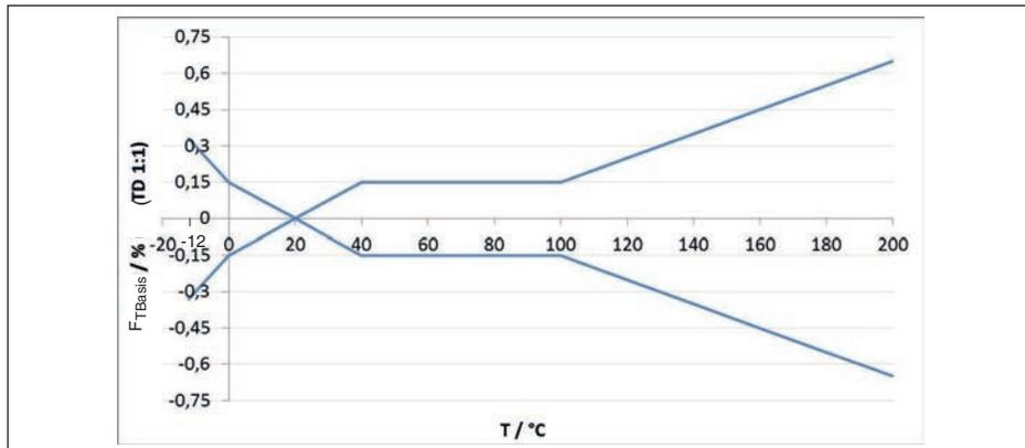
Fig. 33: Erro de temperatura básico  $F_{TBasis}$  com TD 1 : 1
