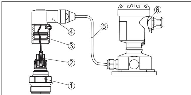
Fig. 30: IPT-2x como modelo IP68 de 25 bar e saída lateral do cabo, caixa externa
