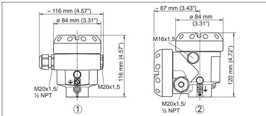
Fig. 41: Variantes da caixa com grau de proteção IP66/IP68 (0,2 bar), (com o módulo de visualização e configuração montado, a altura da caixa é aumentada em 9 mm/0,35 in)
