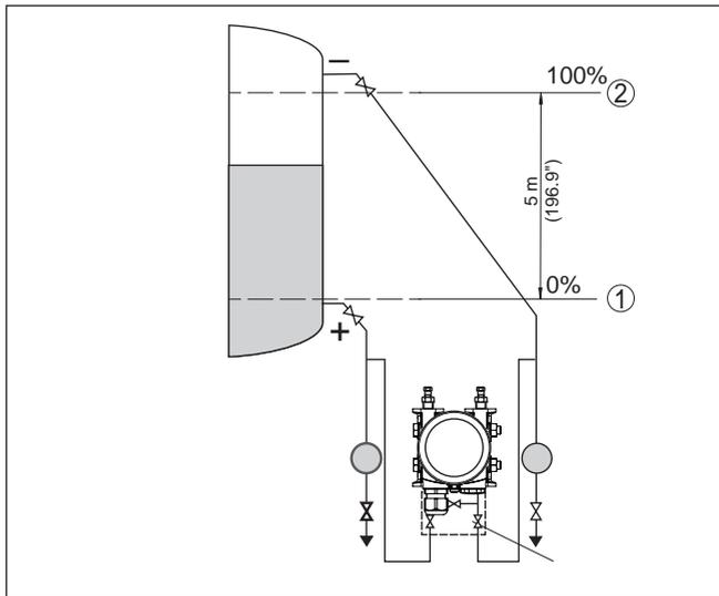
Fig. 42: Exemplo de parametrização Calibração Min./Máx. Medição do nível de enchimento
