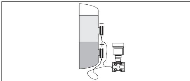
Fig. 6: Medição de camada separadora com o DPT-20
