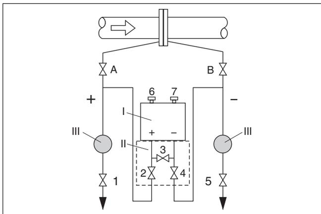
Fig. 47: Disposição preferencial para a medição de líquidos
