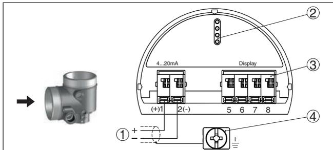
Fig. 30: Compartimento de conexão - Caixa de duas câmaras
