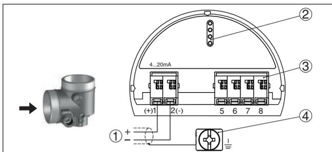
Fig. 33: Compartimento de conexão - Caixa de duas câmaras
