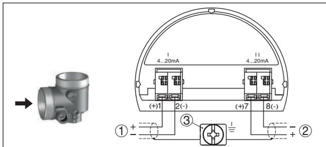
Fig. 31: Compartimento de conexão caixa de duas câmaras, sistema eletrônico adicional "saída de corrente adicional"
