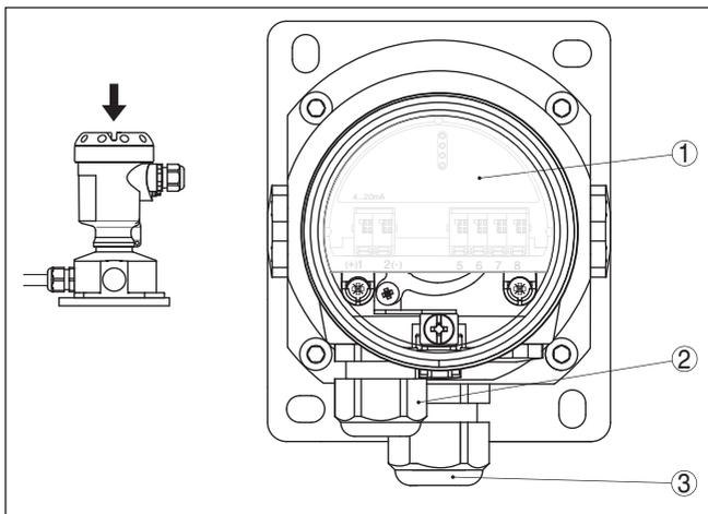
Fig. 35: Compartimento do sistema eletrônico e de conexão
