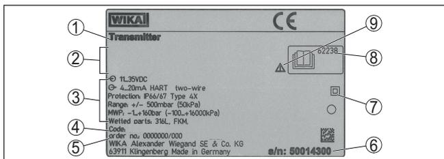
Fig. 1: Estructura de la placa de tipos (ejemplo)
