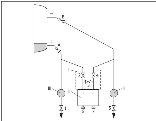
Fig. 43: Configuración de medición preferida para depósitos cerrados
