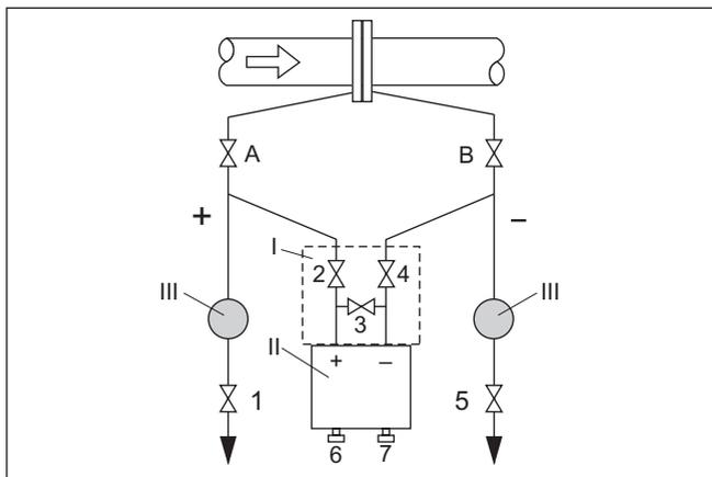
Fig. 46: Configuración de medición preferida para líquidos
