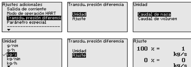
Además, se realiza el ajuste para el flujo volumétrico o másico para 0 % o 100 %.
