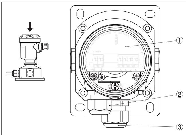
Fig. 34: Compartimento de la electrónica y de conexiones
