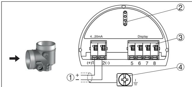
Fig. 29: Compartimiento de conexiones - Carcasa de dos cámaras
