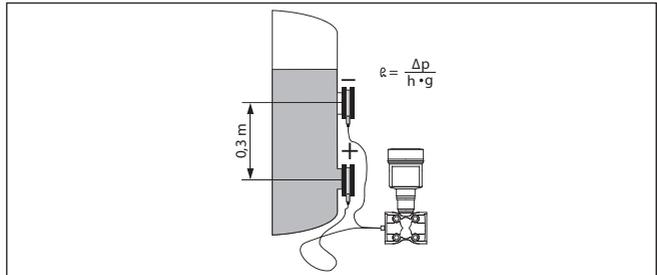
Fig. 24: Configuración de medición para medición de densidad
