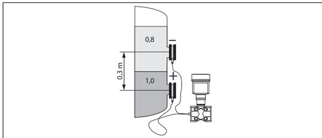
Fig. 25: Configuración de medición para medición de interface
