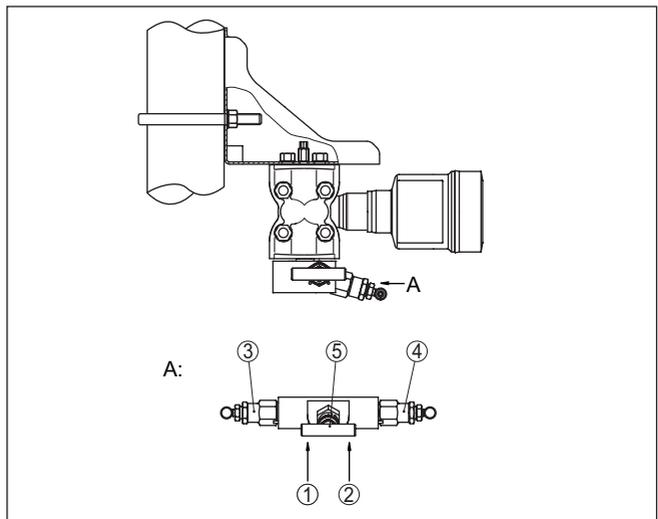
Fig. 10: Conexión de un bloque de 3 válvulas
