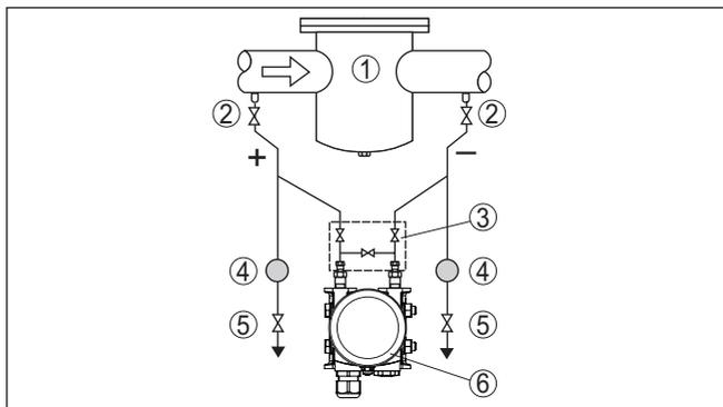
Fig. 22: Configuración de medición para la medición de presión diferencial en líquidos
