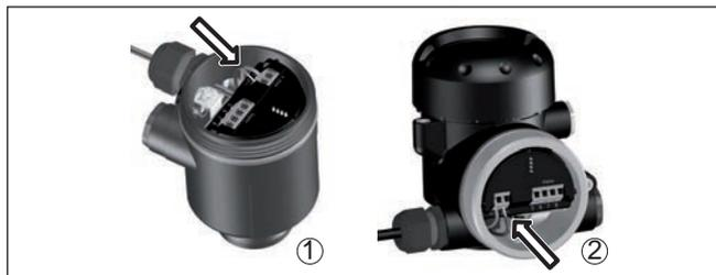
Fig. 27: Passos 5 e 6 do procedimento de conexão
