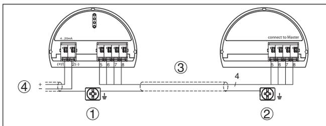
Fig. 27: Ejemplo de conexión presión diferencial electrónica
