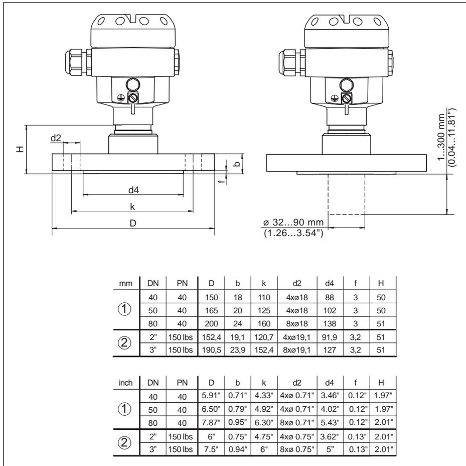
Fig. 42: CPT-2x, Conexión de brida
