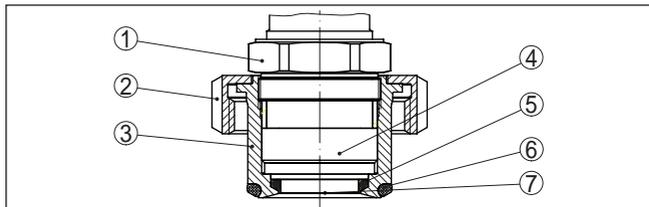
Fig. 29: CPT-2x, estructura de la conexión aséptica con tuerca de unión ranurada
