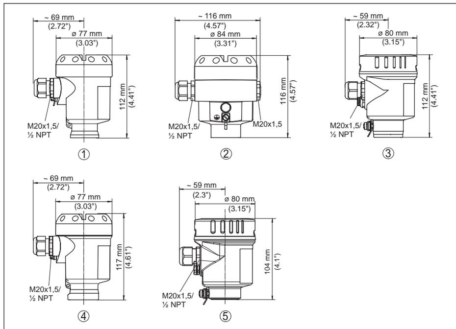
Fig. 37: Versiones de carcasa en grado de protección IP66/IP67 e IP66/IP68 (0,2 bar)
