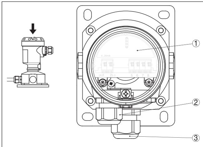
Fig. 24: Compartimento de la electrónica y de conexiones
