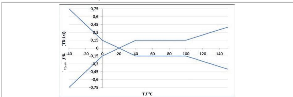
Fig. 32: Error de temperatura básico  $F_{TBasis}$  con TD 1 : 1
