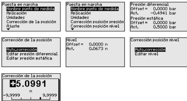
Para la corrección de posición automática se acepta el valor medido actual como valor de corrección. Ese valor no puede estar alterado por recubrimiento de producto o una presión estática.
