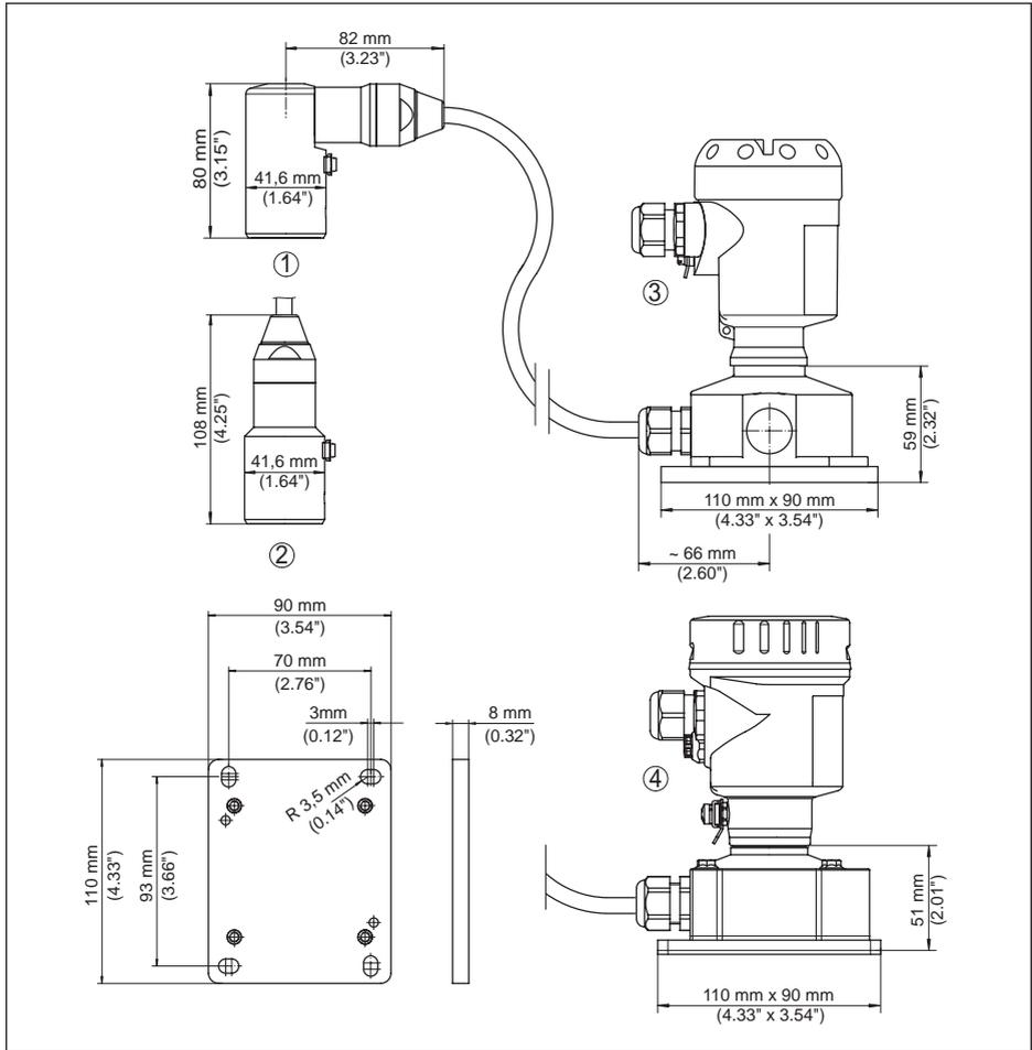
Fig. 38: Versión IP68 con carcasa externa
