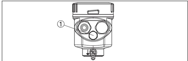
Fig. 14: Posición del elemento de filtrado - versión IP69K
