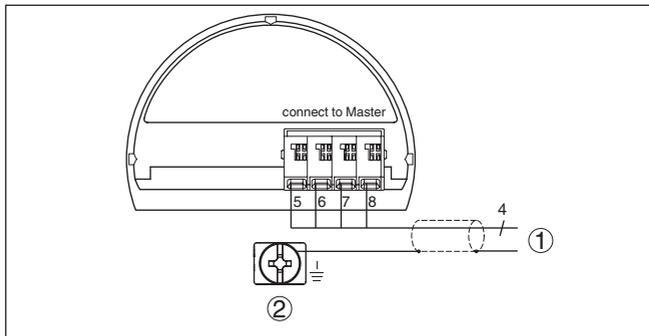
Fig. 26: Esquema de conexión CPT-2x sensor slave
