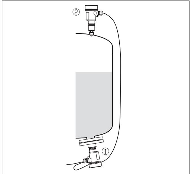
Fig. 15: Configuración de medición para medida de nivel en depósito presurizado
