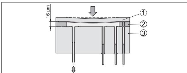
Fig. 3: Estructura de la celda de medida cerámica
