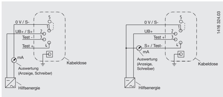
Als Hilfsenergie genügt eine unstabilisierte Gleichspannung im Bereich der angegebenen Grenzen. Es ist darauf zu achten, dass die angelegte Versorgungsspannung um den Betrag höher ist als die maximal erforderliche Spannung, die an den externen Anzeige- und Auswertegeräten abfällt, d. h. dass die am Druckmessumformer anliegende Spannung nicht unter 10 V, bei Ausführung mit LCD-Anzeige nicht unter 14 V abfällt.
