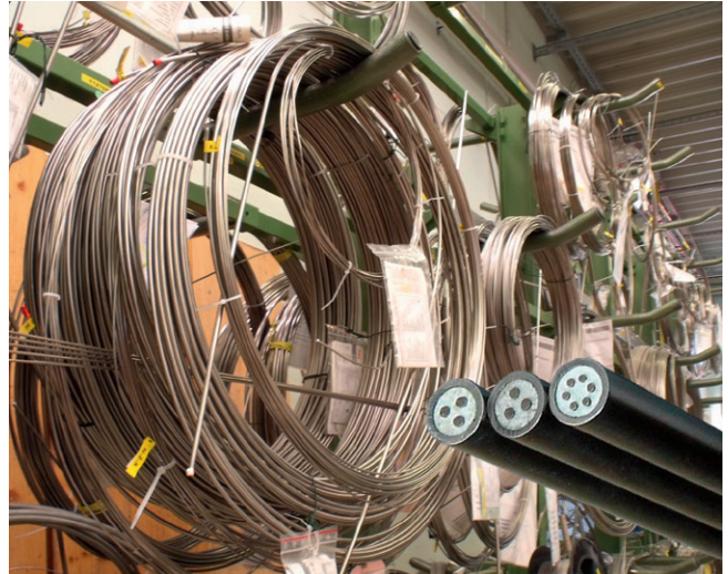
Mineralisierte Leitung (MI-Leitung)
