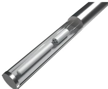
Nestas termorresistências, toda a parte do sensor é composta por um cabo revestido de metal com isolamento mineral (cabo MIMS). Este possui uma bainha externa de aço inoxidável, que contém os condutores internos isolados, isolados por um material cerâmico de alta densidade. O resistor de medição é ligado diretamente aos condutores internos do cabo com bainha.
