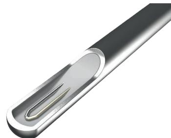
Nos termopares com bainha, a parte flexível do sensor é composta por um cabo revestido de metal com isolamento mineral (cabo MIMS). Este possui uma bainha externa de metal, que contém os condutores internos isolados, envolvidos por um composto de cerâmica de alta densidade. Os termopares com bainha, devido à sua flexibilidade e possibilidade de pequenos diâmetros, podem ser usados em áreas de difícil acesso.
