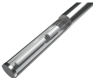
En los termómetros de resistencia encamisados, la parte flexible de la sonda consiste en un cable metálico con aislamiento mineral (cable MIMS). Éste consiste en un encamisado de acero inoxidable, en el cual los conductores interiores están encapsulados en una masa de cerámica altamente compactada. El sensor RTD va directamente unido a los conductores internos del cable encamisado.
