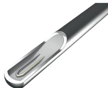
En termopares con encamisado, la parte flexible de la sonda consiste en un cable con aislamiento mineral (cable MIMS). Éste consiste en un encamisado metálico, en el cual los conductores interiores están encapsulados en una masa de cerámica altamente compactada. Los termopares encamisados, gracias a su flexibilidad y a los pequeños diámetros posibles, pueden utilizarse en zonas de difícil acceso.
