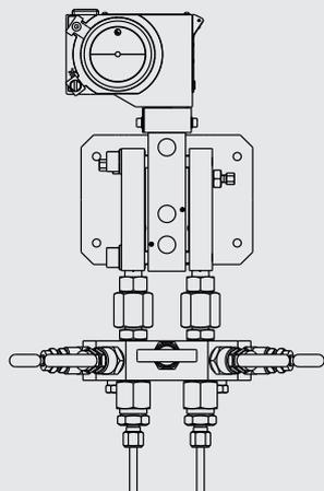
Montaje por medio de juntas capilares a los separadores
