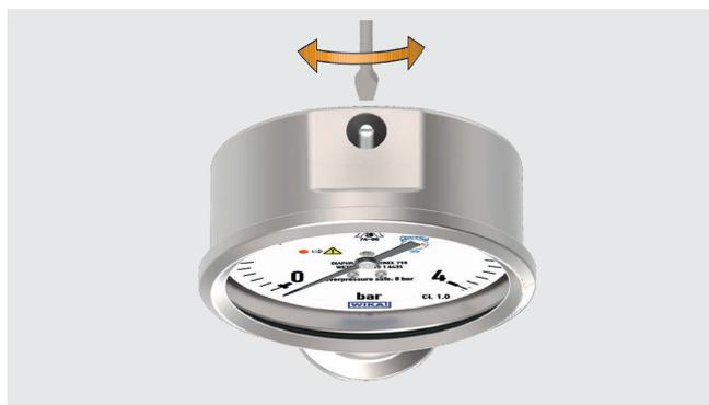
El ajuste del punto cero se puede hacer con un destornillador plano tras quitar el tapón de obturación en la parte superior de la caja.
