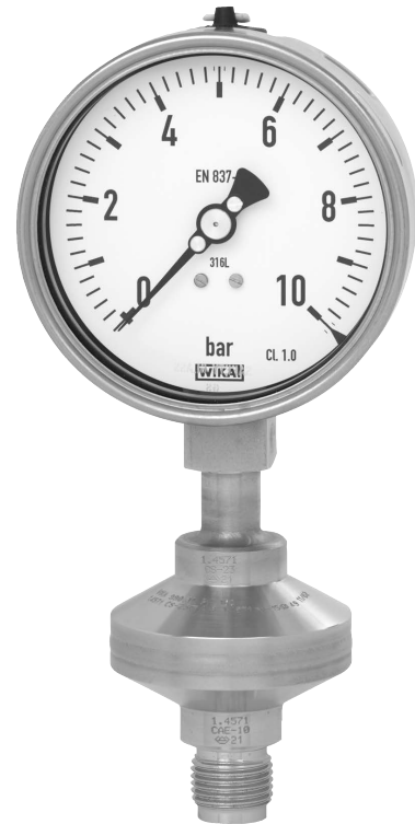
Selo diafragma modelo 990.34, Mb 52 mm Conexão ao processo rosqueado G ½ B (macho) com manômetro modelo 232.50 DN 100
