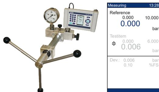
**Esempio: CPH6000 con sensore di pressione campione saldamente fissato, torchietto di confronto e strumento in prova specifico del cliente**
