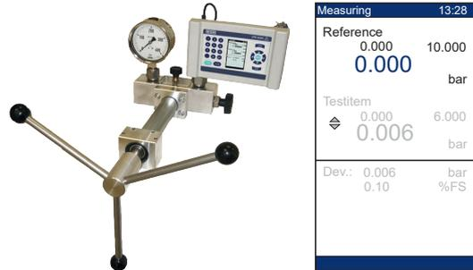
Exemple : CPH6000 avec capteur de pression de référence fixe, pompe manuelle à vérin et instrument sous test spécifique au client
