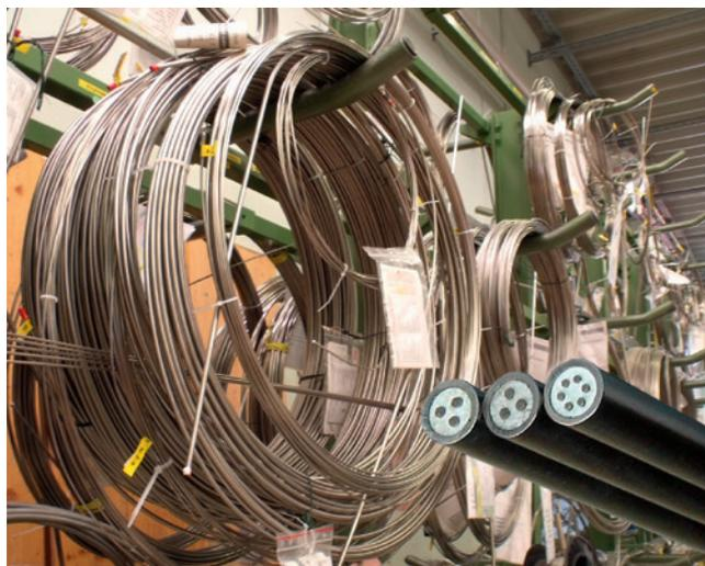
Cavo con isolamento minerale (cavo MI)
