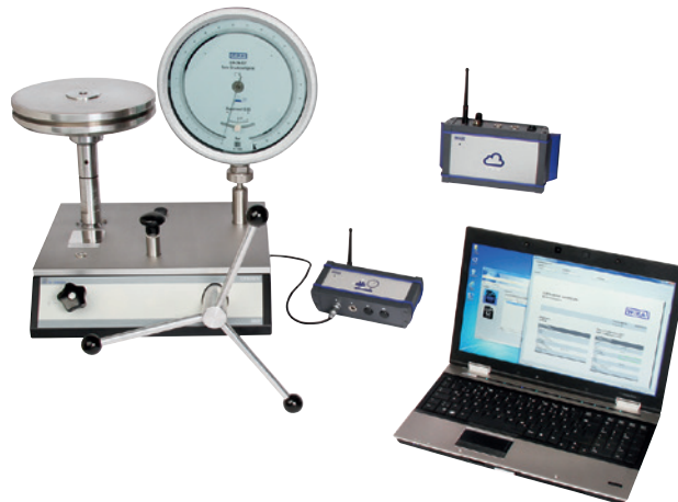
Typ CPU6000-W, CPU6000-S, CPB5800 und PC mit Software WIKA-Cal
