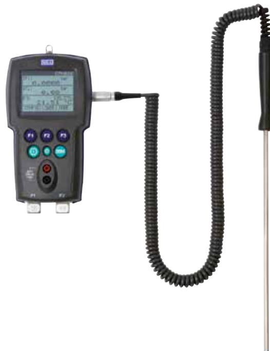
Model CPH6510-S2 iskrobezpečny kalibrator ciśnienia z termometrem rezystancyjnym Pt100.
